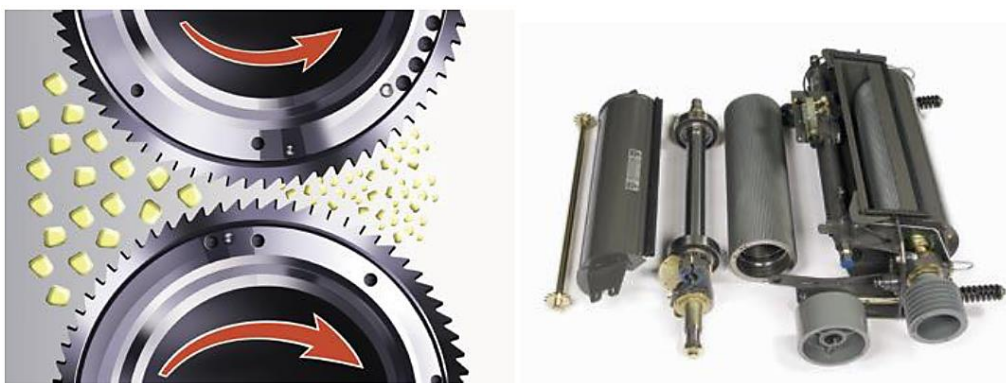
Рис. 1.4. Подрібнююча система CORN CRACKER комбайна CLAAS JAGUAR
