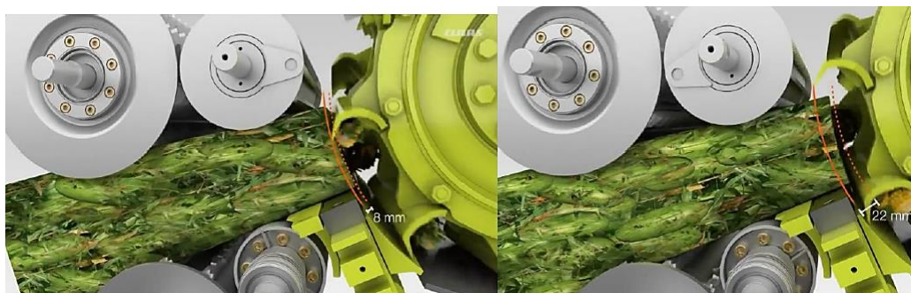
Рис. 2.3. Моделювання процесу формування з ущільненням маси та подрібнення
