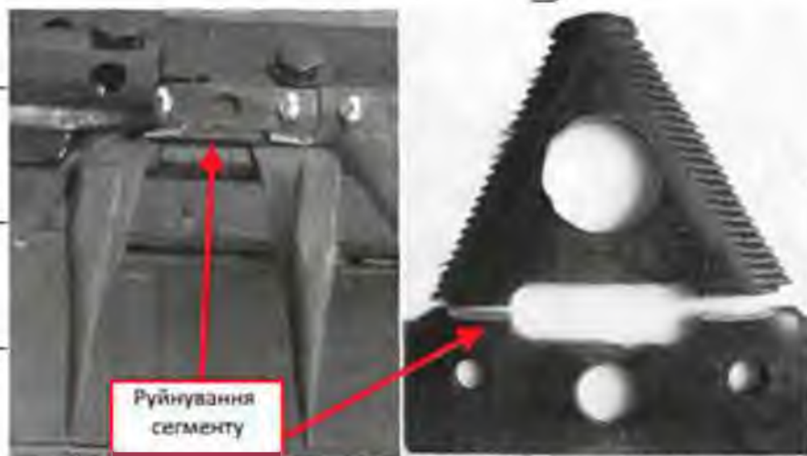
Рисунок 4.6 – Результати випробувань сегментів ріжучого апарату: а) стандартний сегмент; б) експериментальний сегмент
