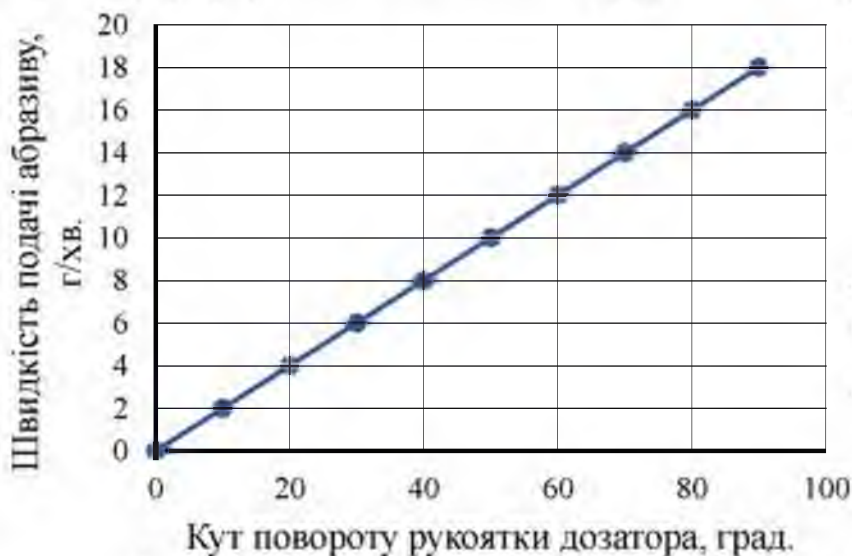
Рисунком 3.11 - Загальний вид дозатора та тарувальний графік подачі абразиву
