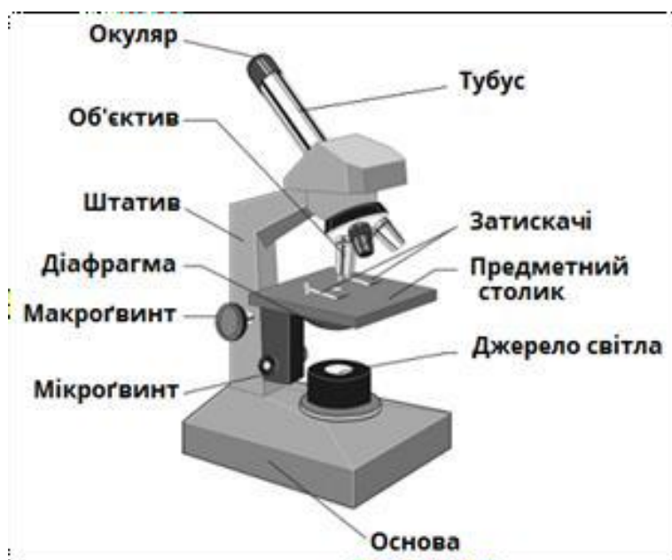
Рис. 2.4 Будова світлопольного мікроскопа [33]
