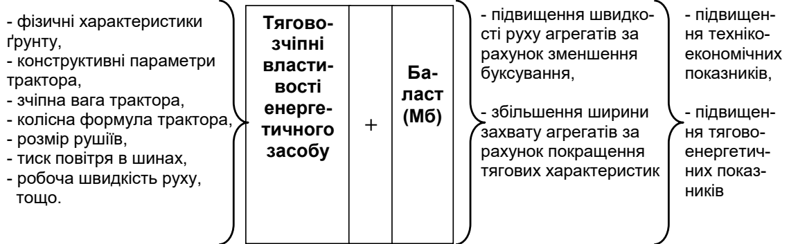
Рис. 2. Ефект покращення тягово-зчіпних властивостей енергетичного засобу з баластом
