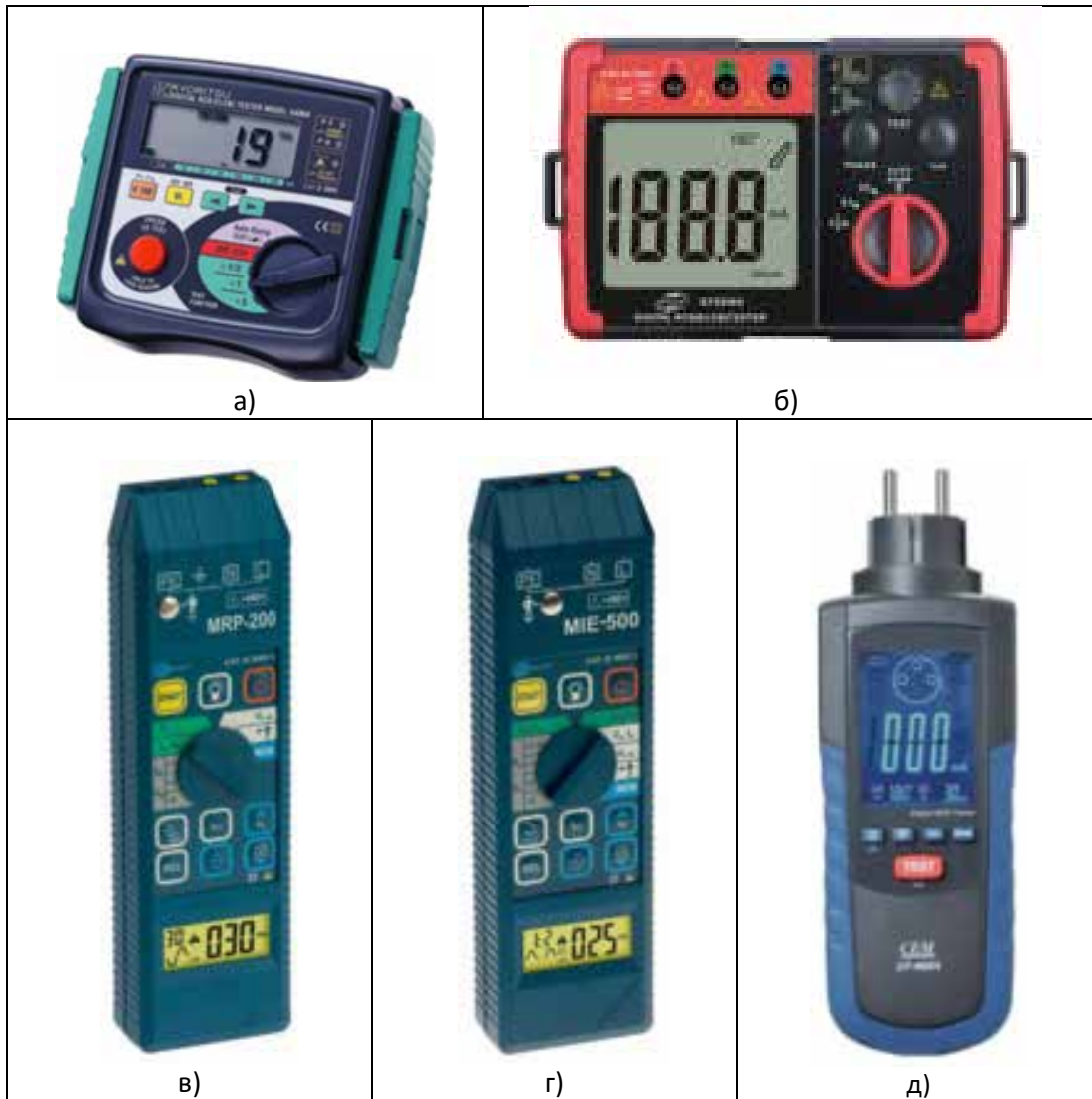
Рис. 6.16. Приладове забезпечення перевірки пристроїв захисного вимикання:
