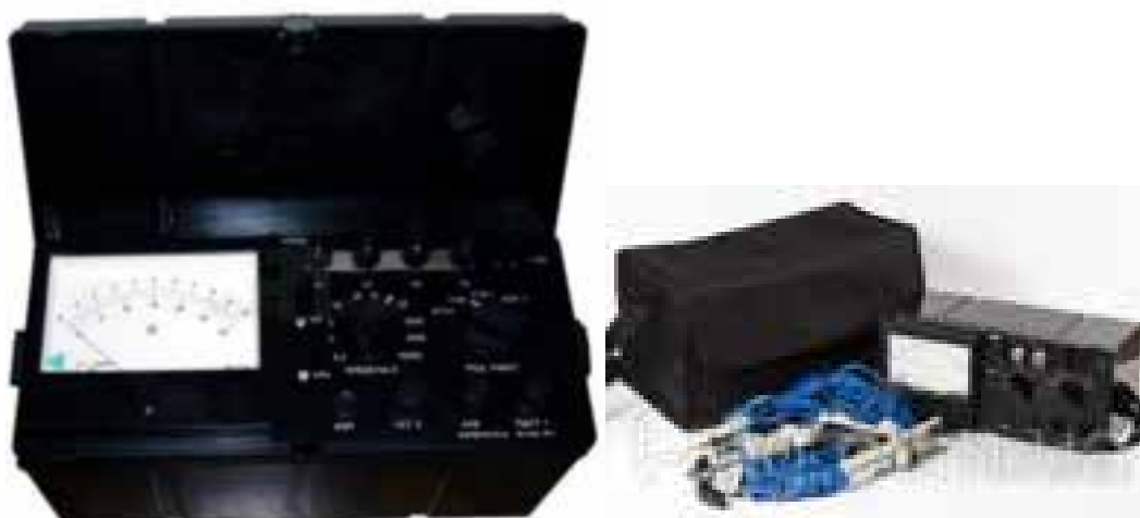
Рис. 2.36. Вимірювач опору заземлення Ф4103-М1
