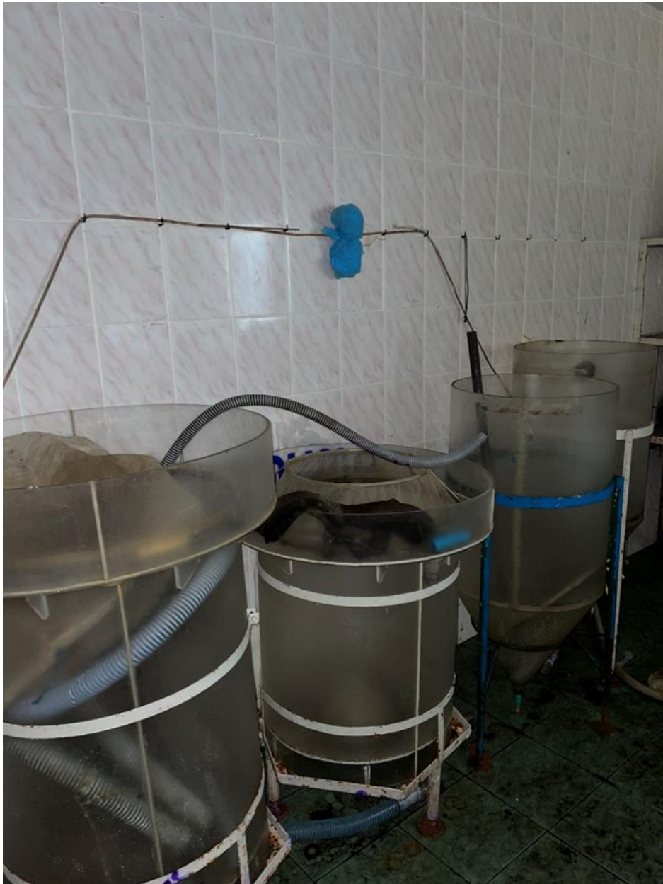
Рис. 3.3. Апарати типу «Амур» в інкубаційному цеху
