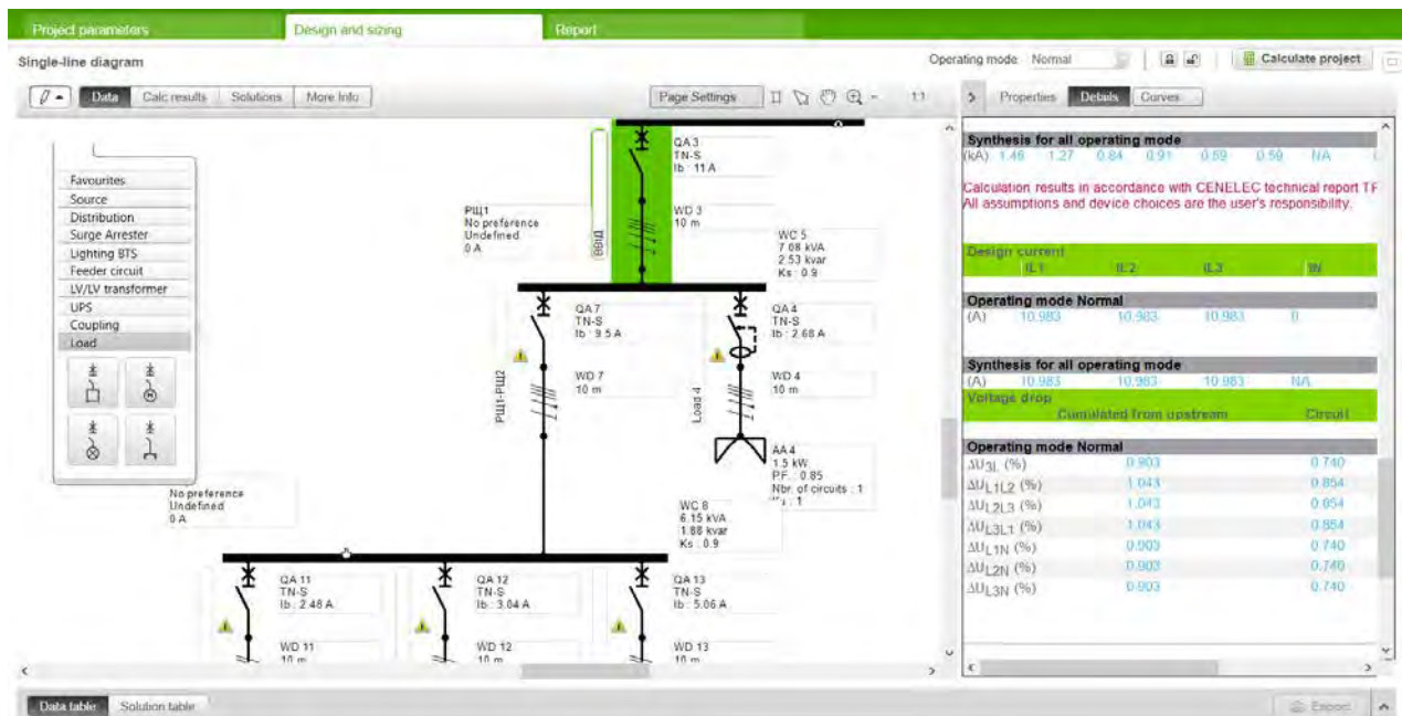
Рис. 3.4. Зображення електричної схеми у розділі «Data» вкладки меню «Single-line diagram».
