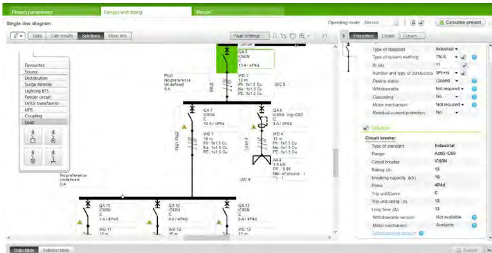
Рис. 3.5. Зображення електричної схеми у розділі «Solutions» вкладки меню «Single-line diagram».
