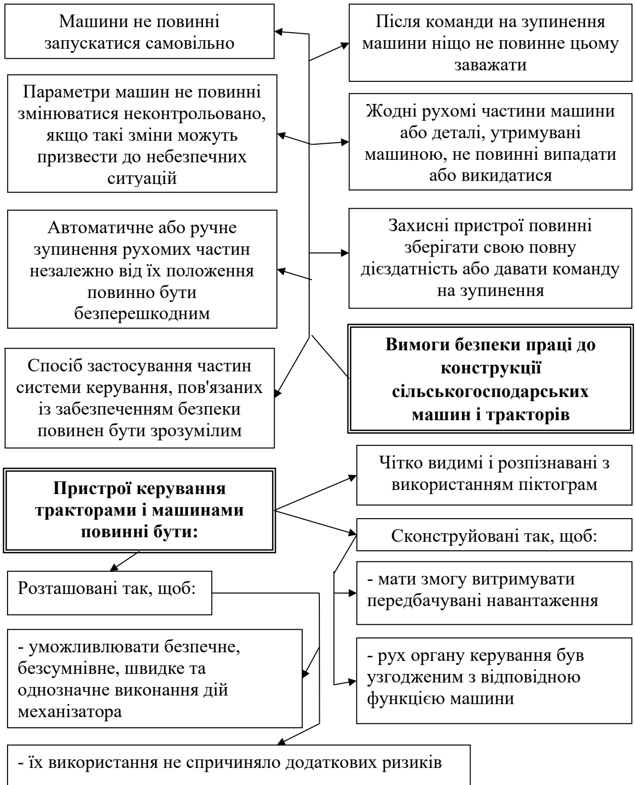
Рис. 5.1. Вимоги безпеки виконання робіт, які висувають до конструкції тракторів (сільськогосподарських машин), а також пристроїв керування ними
