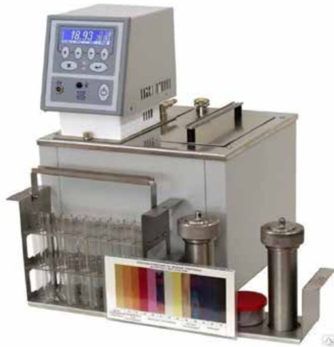
Рисунок 3.3 – Прилад для визначення корозійного впливу на мідну пластину
