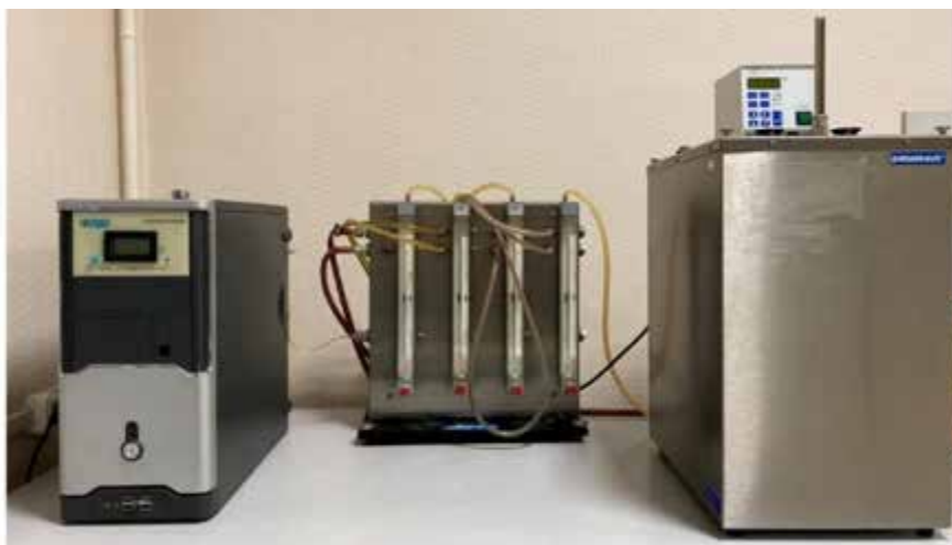
Рисунок 3.8 – Прилад для визначення окислювальної стабільності дизельних палив
