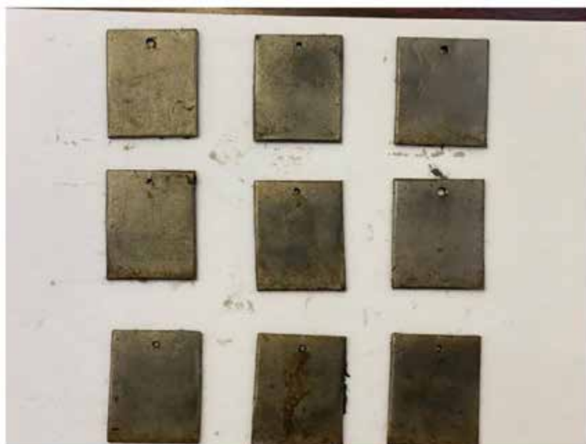
Рисунок 4.8 – Зовнішній вигляд зразків, оброблених РКП з 5% інгібітору корозії АКОР-1
