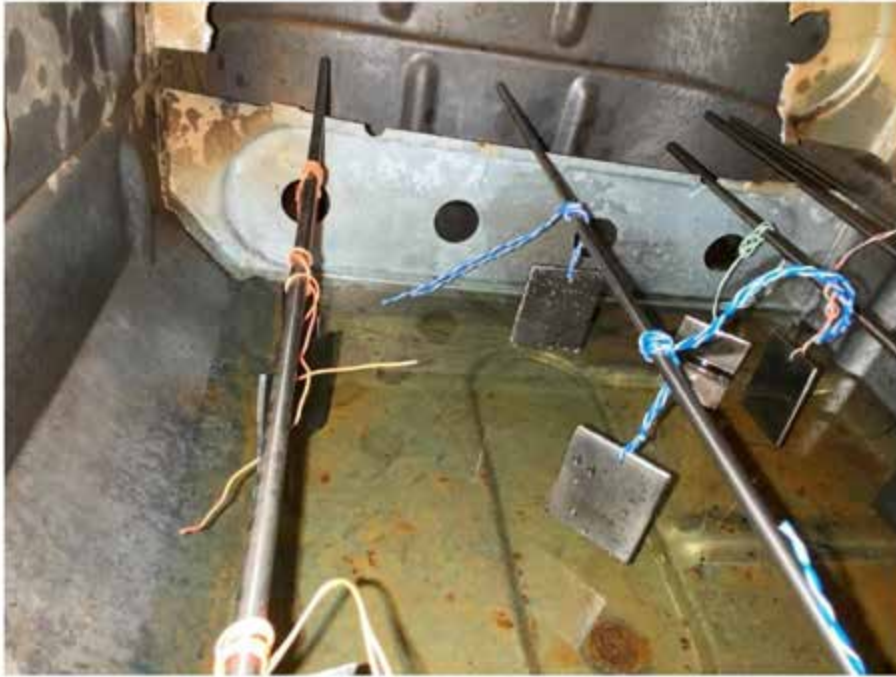
Рисунок 4.4 – Металеві зразки в паливному баку
