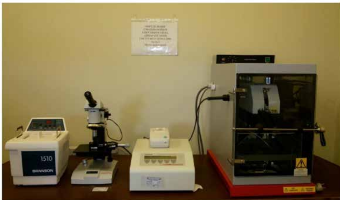
Рисунок 3.7 – Прилад HFRR для визначення змащувальної здатності дизельного палива
