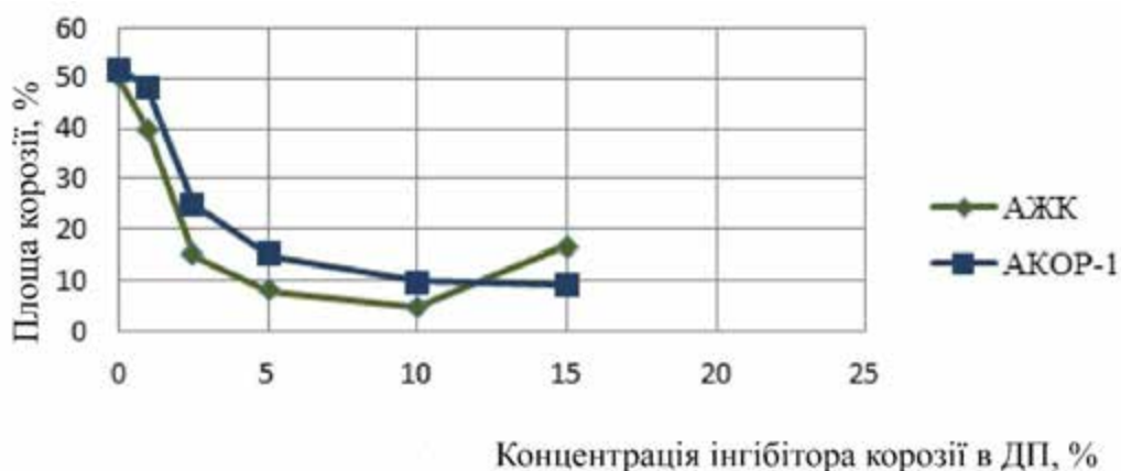
Рисунок 4.1 – Залежність захисних властивостей дизельного палива в залежності від концентрації інгібітору корозії
