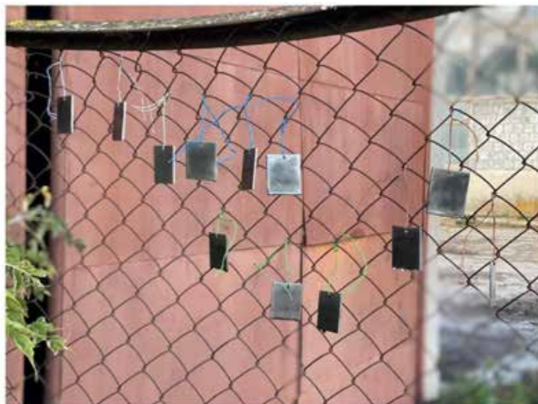
Рисунок 4.6 – Випробувані зразки під впливом кліматичних факторів на відкритому майданчику
