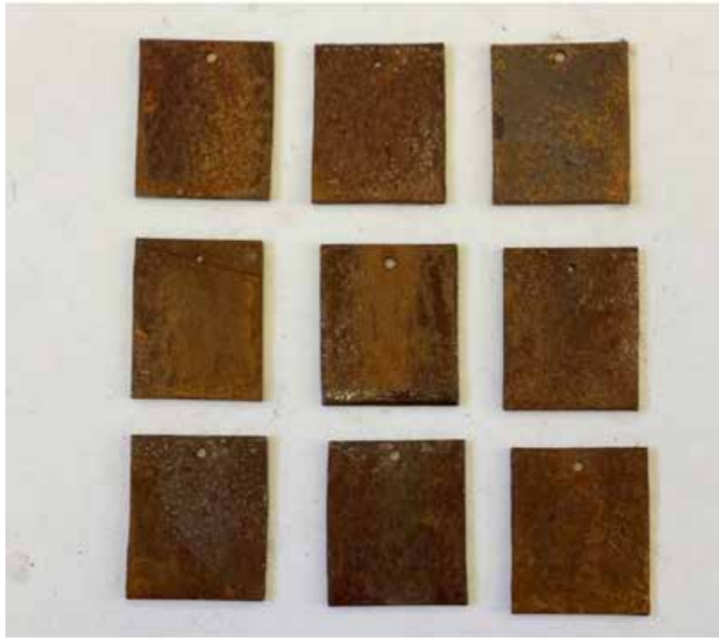
Рисунок 4.12 – Зовнішній вигляд зразків, оброблених РКП із вмістом 2, 5, 10% інгібітора корозії АКОР-1
