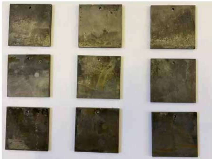
Рисунок 4.10 – Зовнішній вигляд зразків, оброблених з 2% інгібітором корозії АЖК
