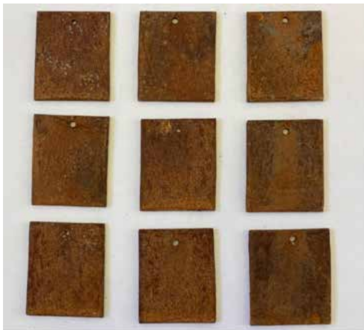
Рисунок 4.11 – Зовнішній вигляд зразків, оброблених РКП з 2, 5, 10 % інгібітору корозії АЖК, що зберігаються на відкритому майданчику
