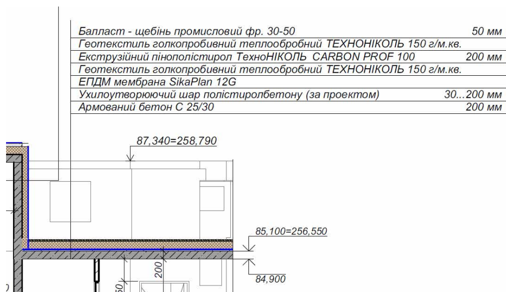
Рис. 1 Склад та структура зовнішньої стіни
