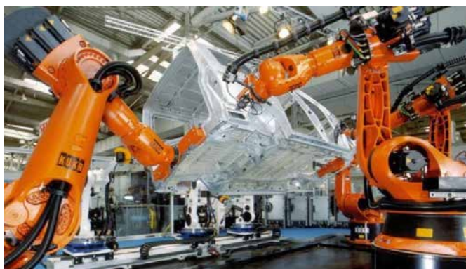
Рис. 1.4. Застосування роботів з електромеханічними хватками
