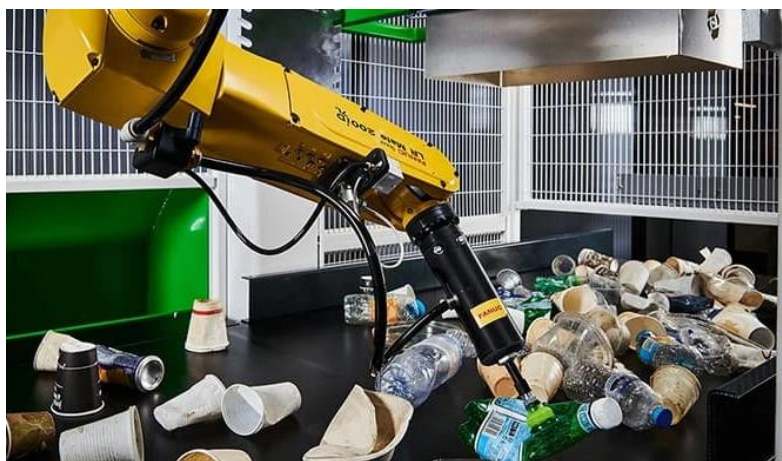
Рис. 1.3. Управління відходами сортувальним роботом
