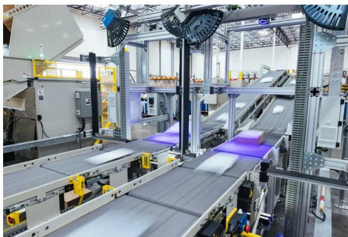
Рис. 1.2. Високопродуктивне сортування посилок для фармацевтичної дистрибуції
