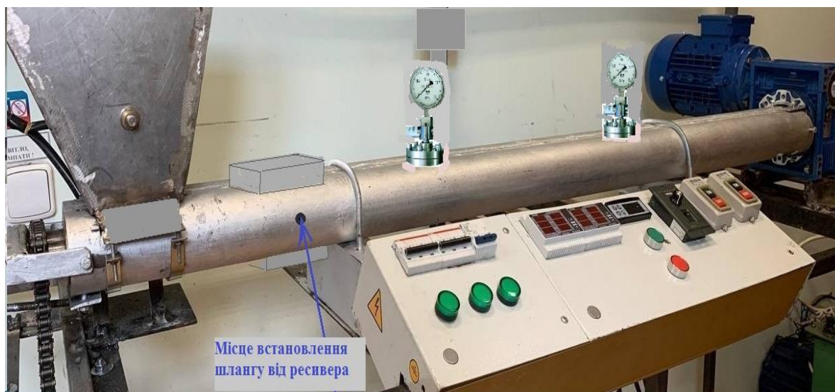
Рис.4.14. Кріплення високотемпературного діафрагмового манометра WIKА А-10
