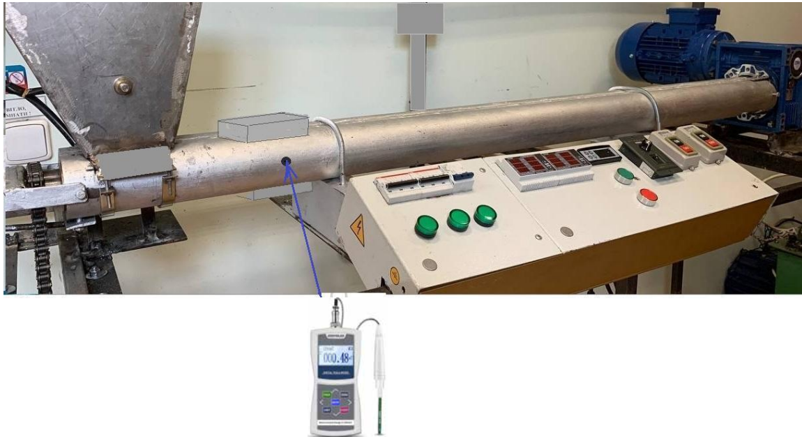
Рис.4.8. Використання тесламетра GOYOJO AMST для виміру магнітного
