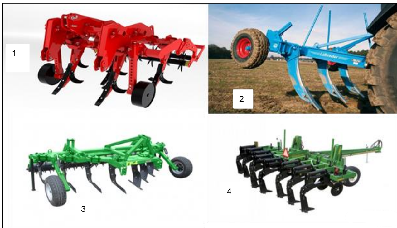
Рис. 3.7. Моделі чизельних глибокорозпушувачів з різними варіантами робочих органів: 1 – АГР-1,7; 2 – Lemken Labrador 160; 3 – GRS 4; 4 – Great Plains SS 1300
