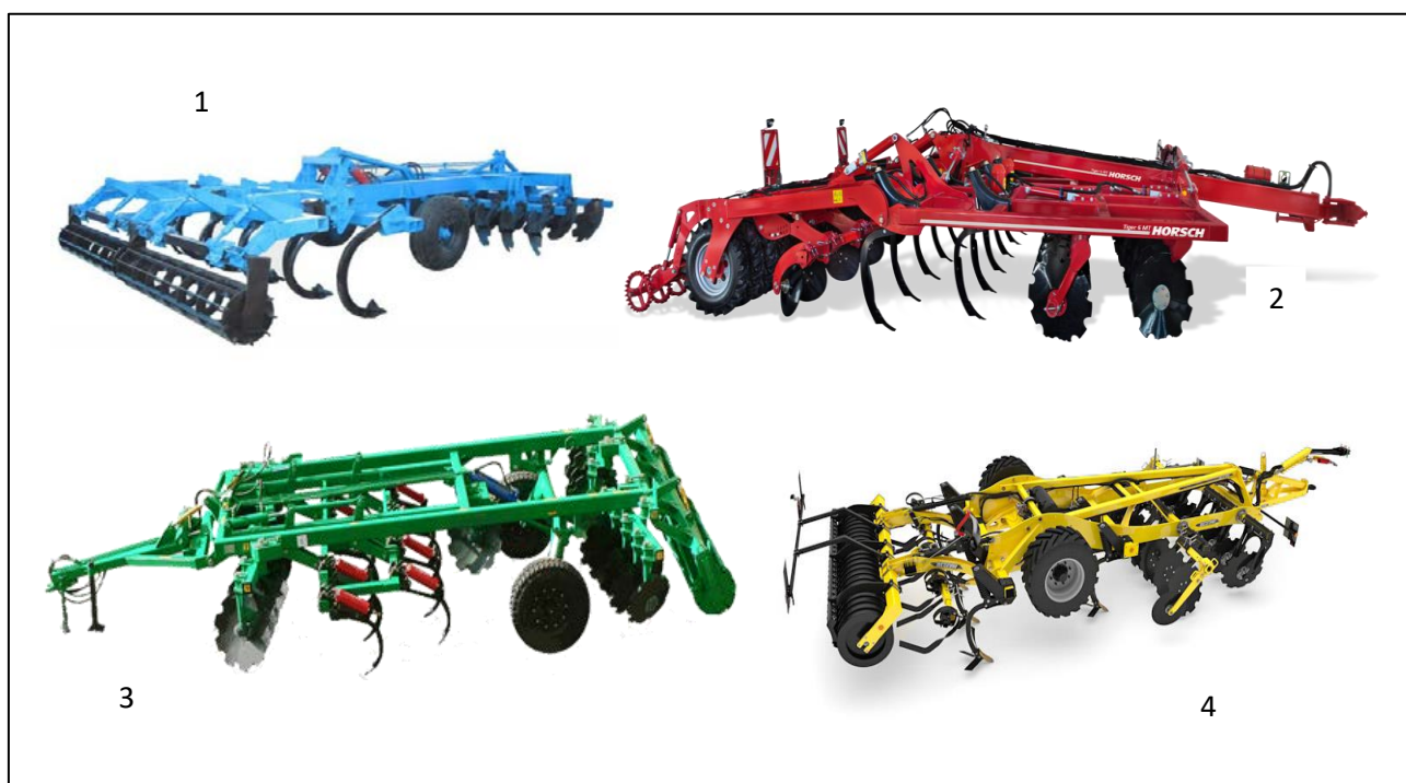
Рис. 3.8. Моделі комбінованих чизельних агрегатів: 1 – АКГР-2,8; 2 – Horsch Tiger MT; 3 – ДИЧ-5,2; 4 – Bednar ACTROS RO
