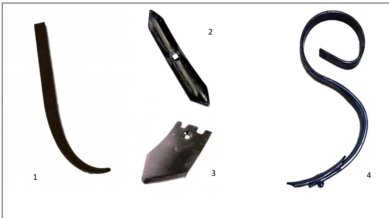
Рис. 3.12. Розпушувальні лапи культиваторів: 1 – долотоподібна; 2, 3 – оборотна та одностороння розпушувальні лапи; 4 – долотоподібна з пружинною стійкою
