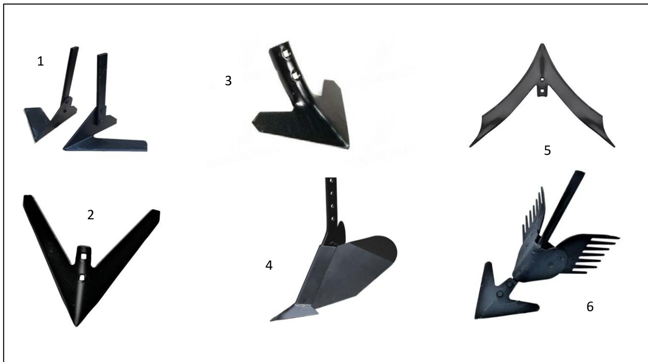
Рис. 3.13. Підрізувальні та підгортальні лапи культиваторів: 1 – однобічна плоскорізальна (бритва); 2 – стрілчаста плоскорізальна, 3 – універсальна; 4, 5, 6 – підпідгортальні лапи
