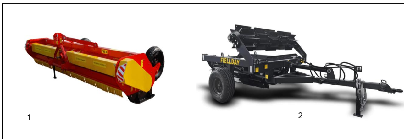
Рис. 3.26. Знаряддя для подрібнення рослинних решток: 1 – мульчер-подрібнювач ПН-4; 2 – рубчатий коток FIELDAY
