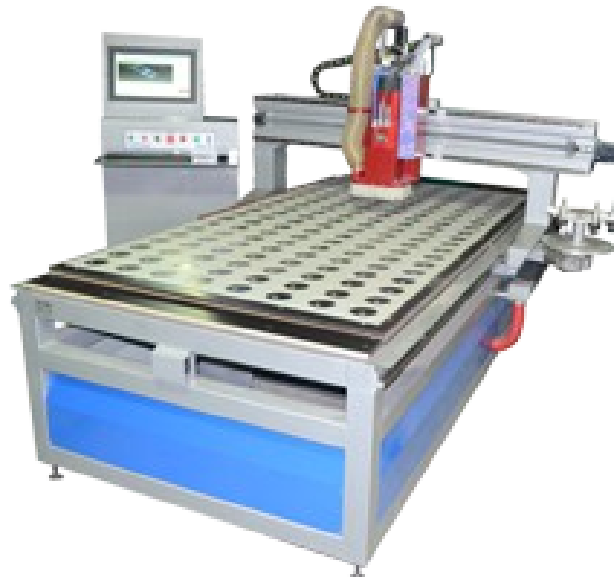
Рис. 2.3. Фрезерний верстат з ЧПК Andis Beta 2/4SM [9]
