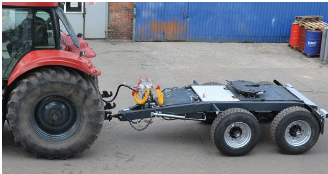
Рис. 2. Трактор в агрегаті із сідельним пристроєм у вигляді підкатного візка
