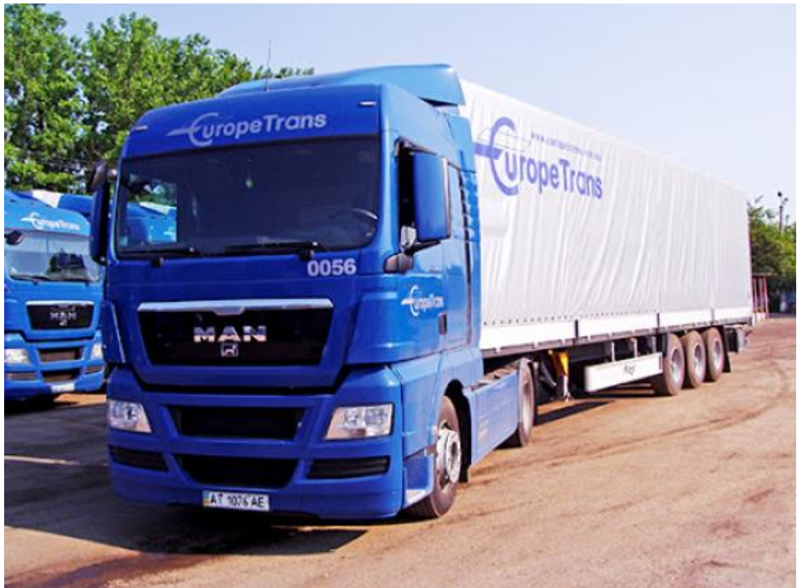
Рисунок 1.1 Зчіпка MAN TGX 18.440 із напівпричепом категорії тент KOGEL.
