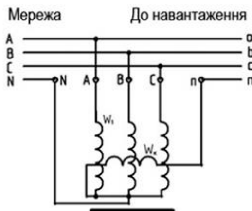
Рис. 3.6 - Автотрансформатор з компенсаційною обмоткою у вигляді витків
