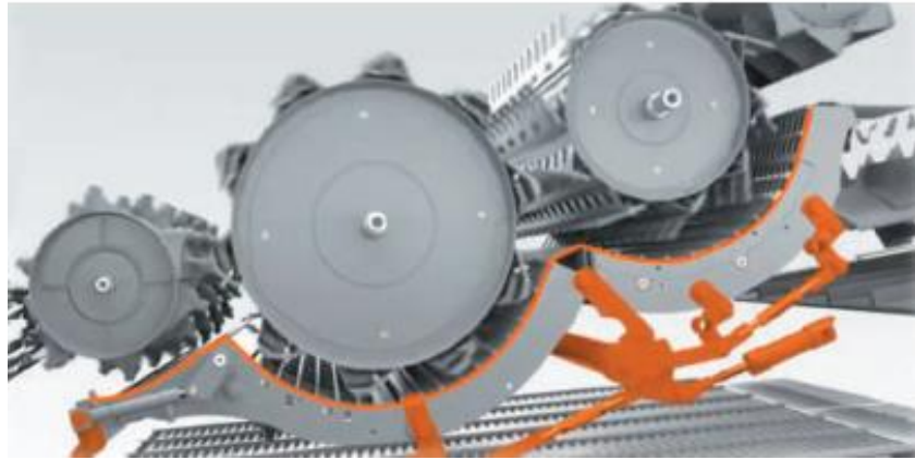
Рис. 22. Молотильний апарат комбайна з барабаном-прискорювачем
