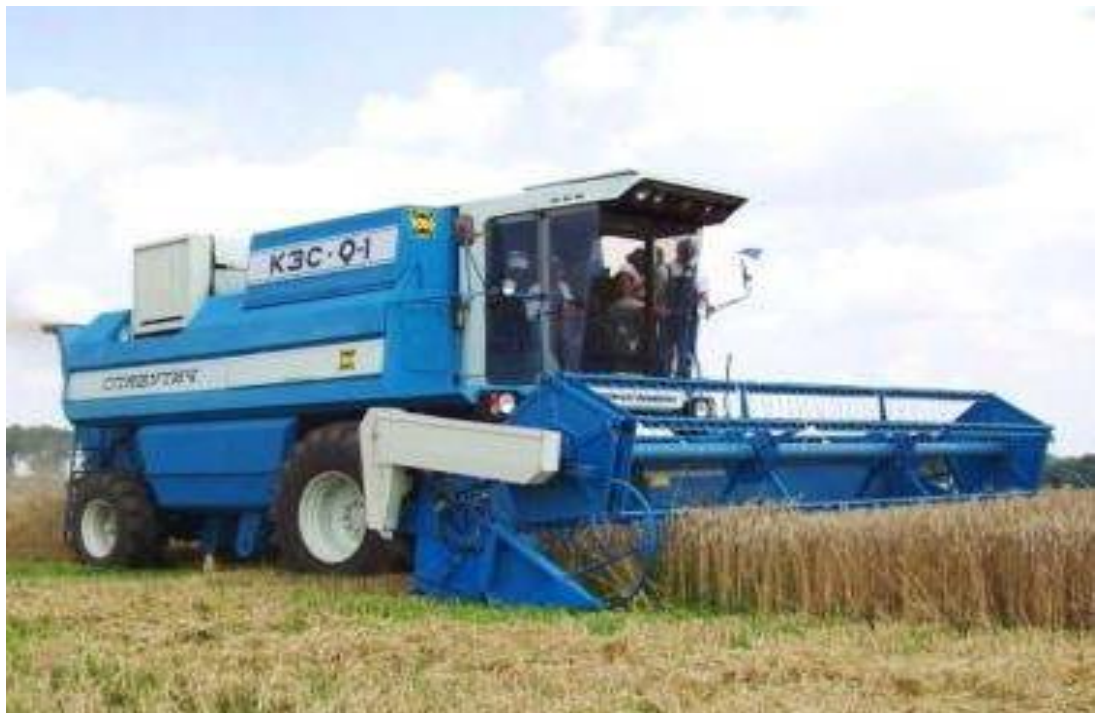
Рис. 21. Робота самохідного зернозбирального комбайна КЗС-9-1 «Славутич» при прямому комбайнуванні
