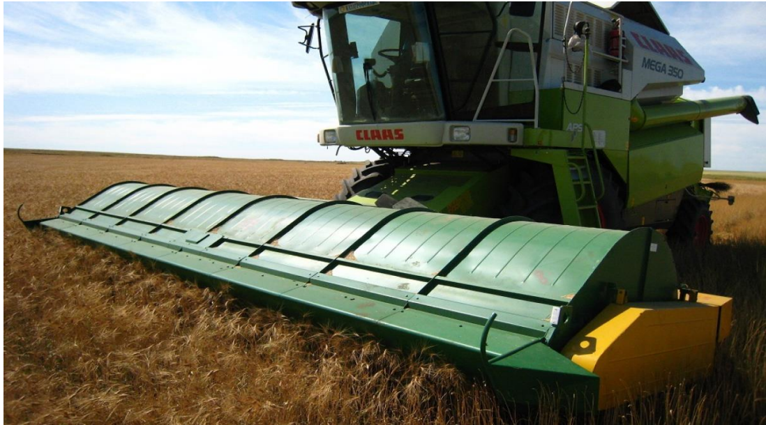
Рис. 11. Зернозбиральний комбайн, який обладнаний обчісувальною жаткою
