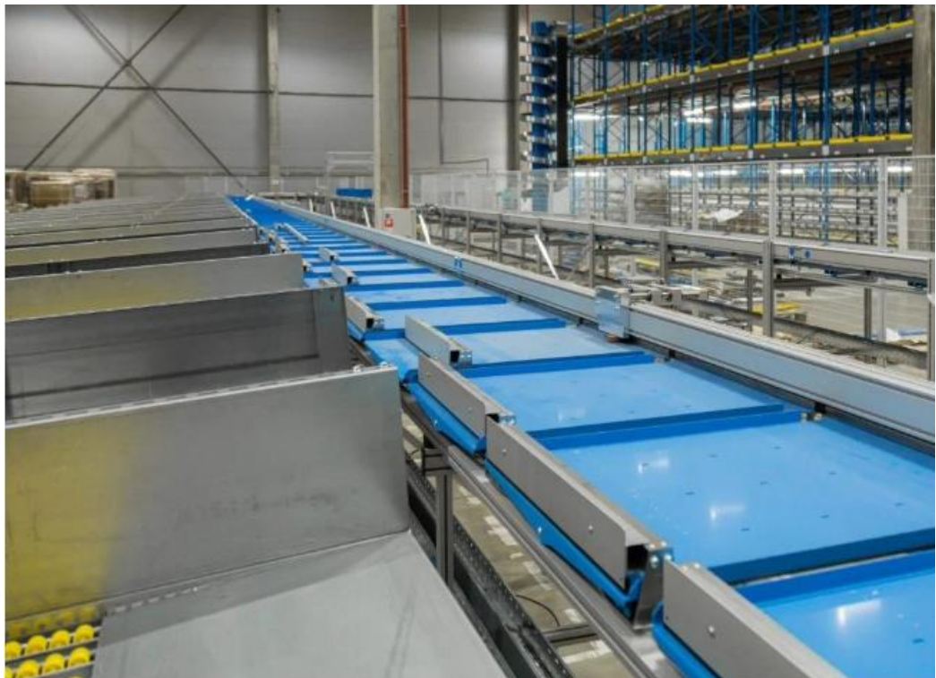
Рис 1.1. Система сортування Push tray сортер
