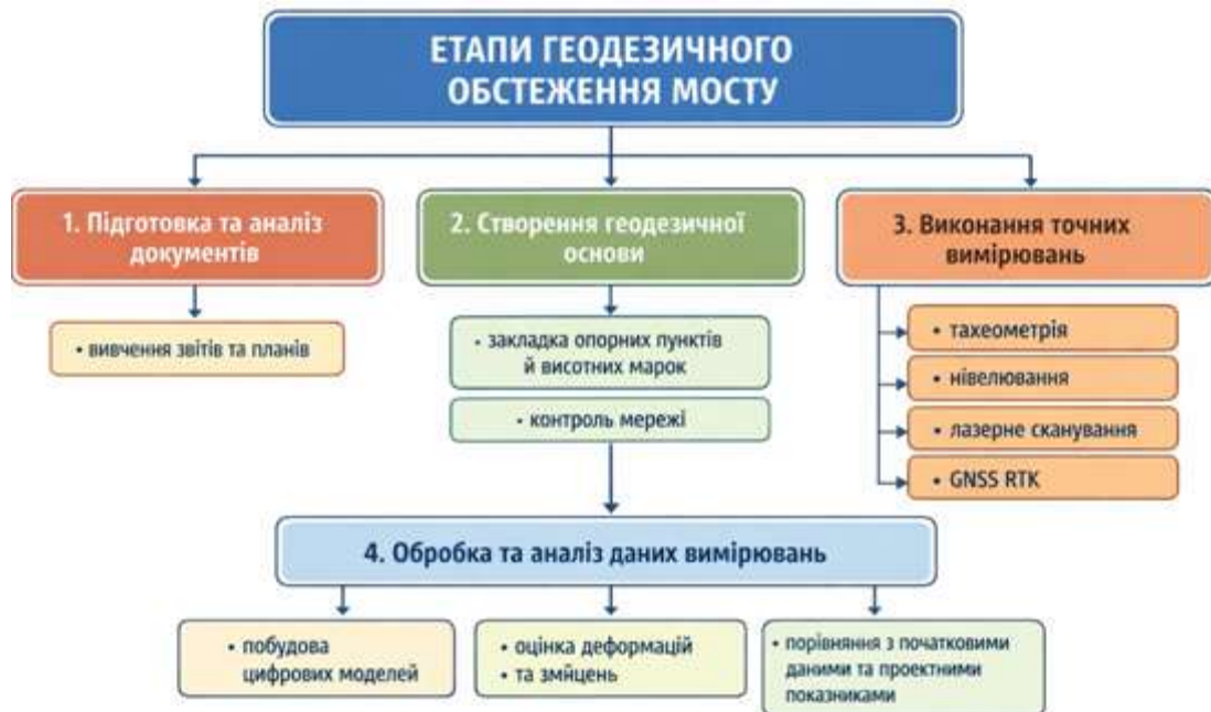
Рис. 1.4. Основні етапи геодезичного обстеження моста [27, с. 72]
