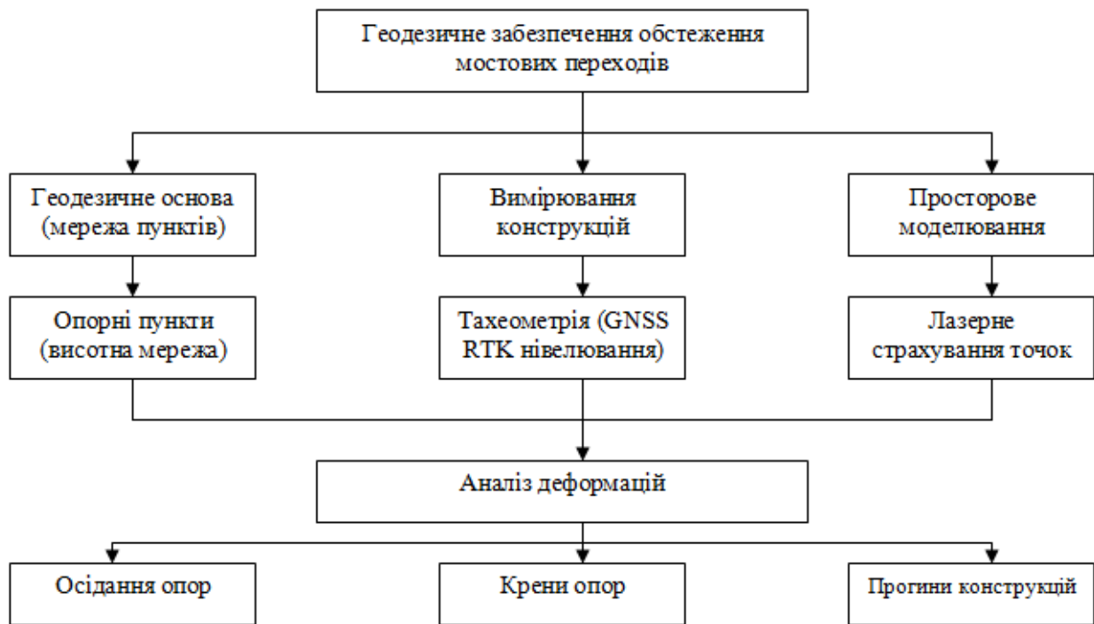
Рис. 1.3. Структура геодезичного забезпечення обстеження мостових споруд [14, с. 118]
