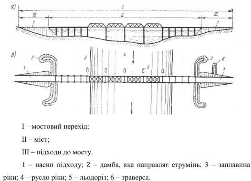
Рис. 1.1. Схема мостового переходу [17]
