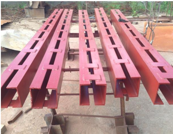
Рис. 2.12. Приклади центрально-стиснутих колон на планках [2]:
