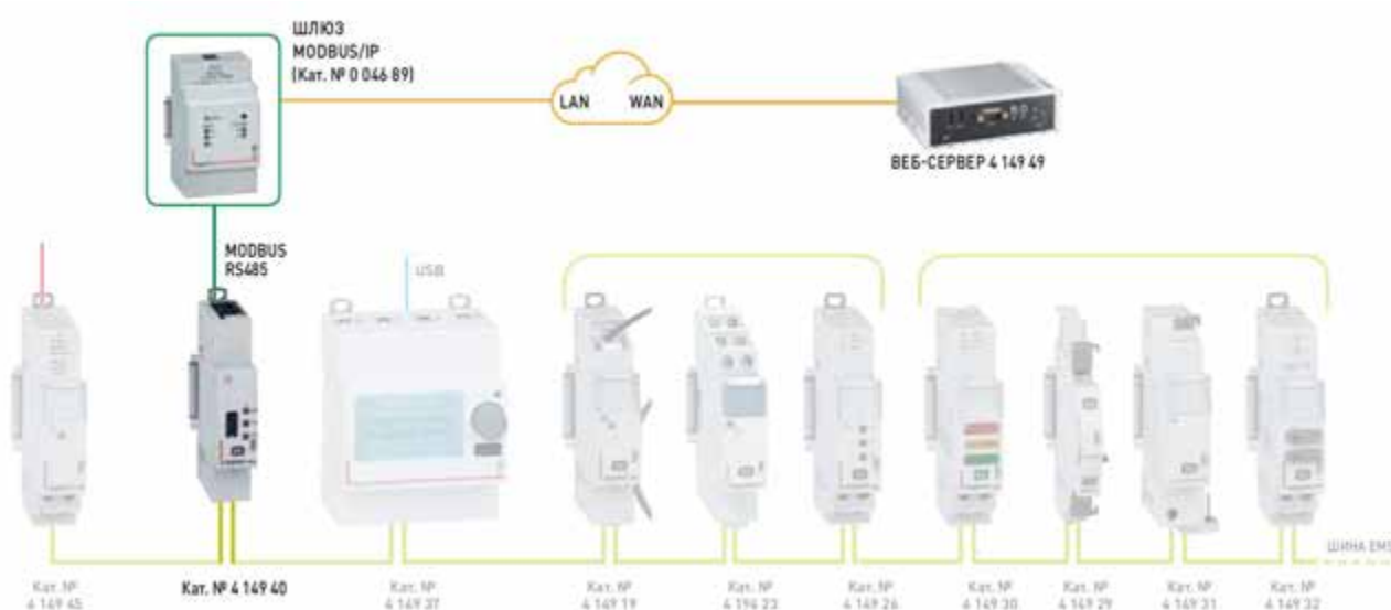
Рис. 3.4. Мережева конфігурація системи енергоуправління CX3 EMS
