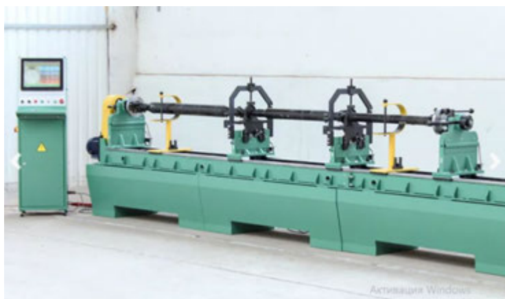
Рис 3.3 Верстат балансувальний БВІ-03-88
