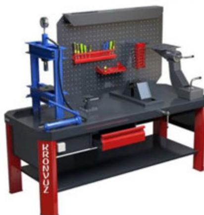
Рис 3.6 Стенд для ремонту карданних валів Р-223
