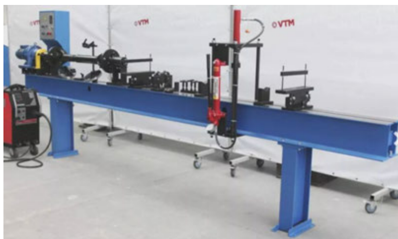
Рис. 3.2 Стенд для зварювання, складання та рихтування карданних валів ПРК-7
