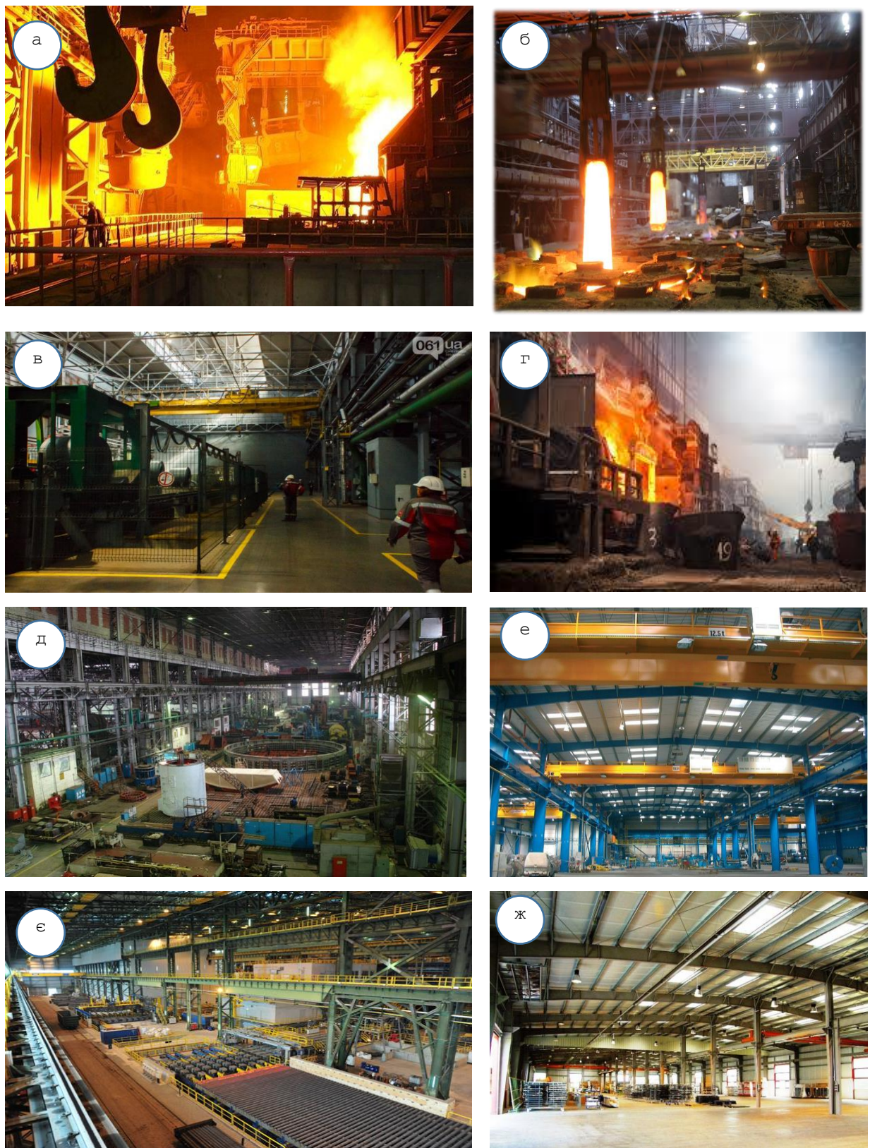
Рис. 1.5. Інтер'єри цехів різного призначення [2]: а – ливарний цех; б – прокатний цех; в – травильне відділення листопрокатного цеху; г – мідеплавильний цех; д, е – механоскладальні цехи; є – склад готової продукції трубопрокатного цеху; ж – складське приміщення
