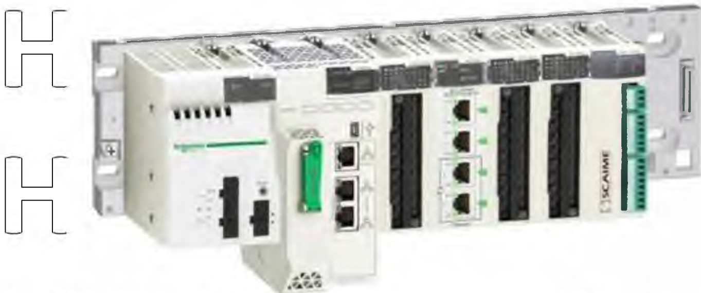
Рис. 3.1. Зовнішній вигляд мікропроцесорного контролера Modicon M580
