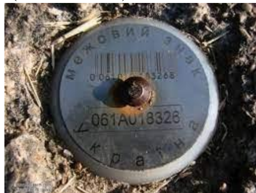
Рис. 1.1 – конструкція зі спеціальних матеріалів, що включає металеву марку круглої форми https://legalaid.wiki/index.php (дата звернення: 30.03.2025)
