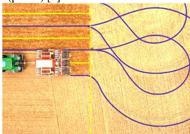
Рис. 2. Траєкторія розвороту агрегату за допомогою AutoTrac [1].
