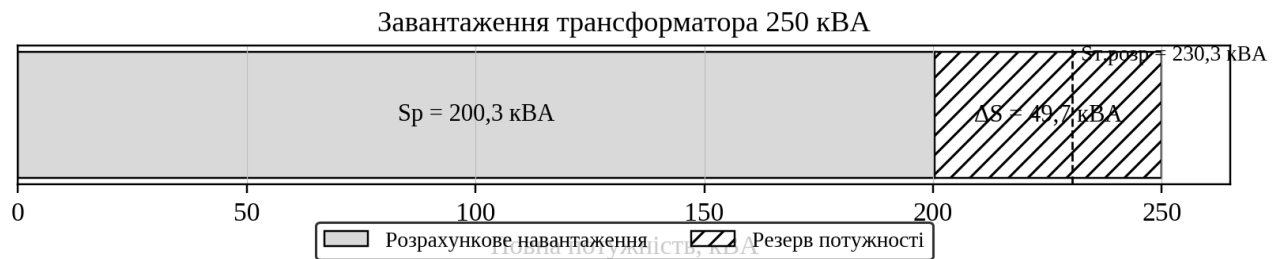
Рисунок 3.2 - Завантаження вибраного силового трансформатора 250 кВА
