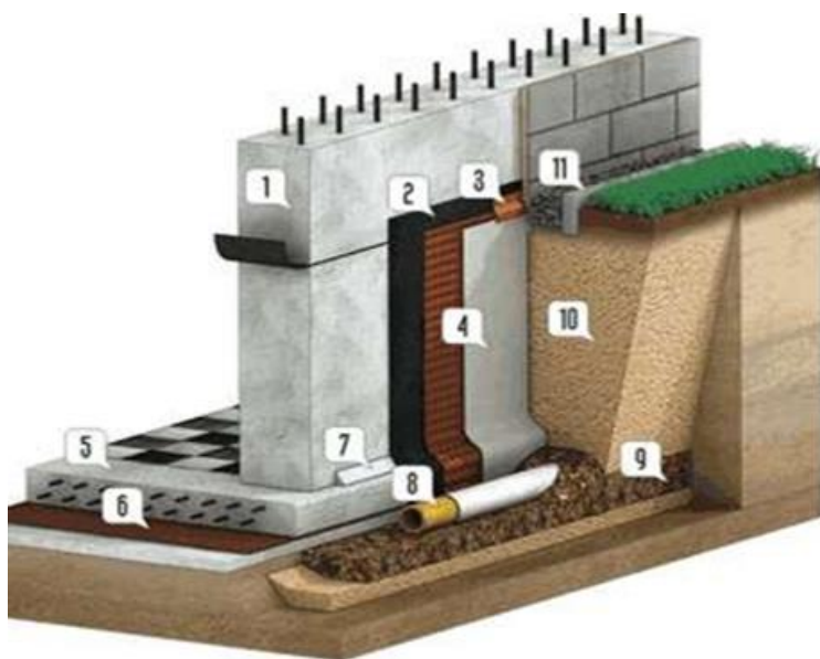
Рис. 4. Конструктивна схема організації пристінного дренажу
