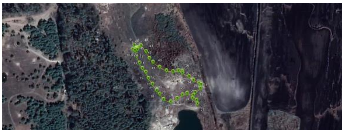
Рис. 3.12. Маршрут проведених вимірів потужності гама-фону неподалік с. Мощун біля вирви від розриву снарядів
