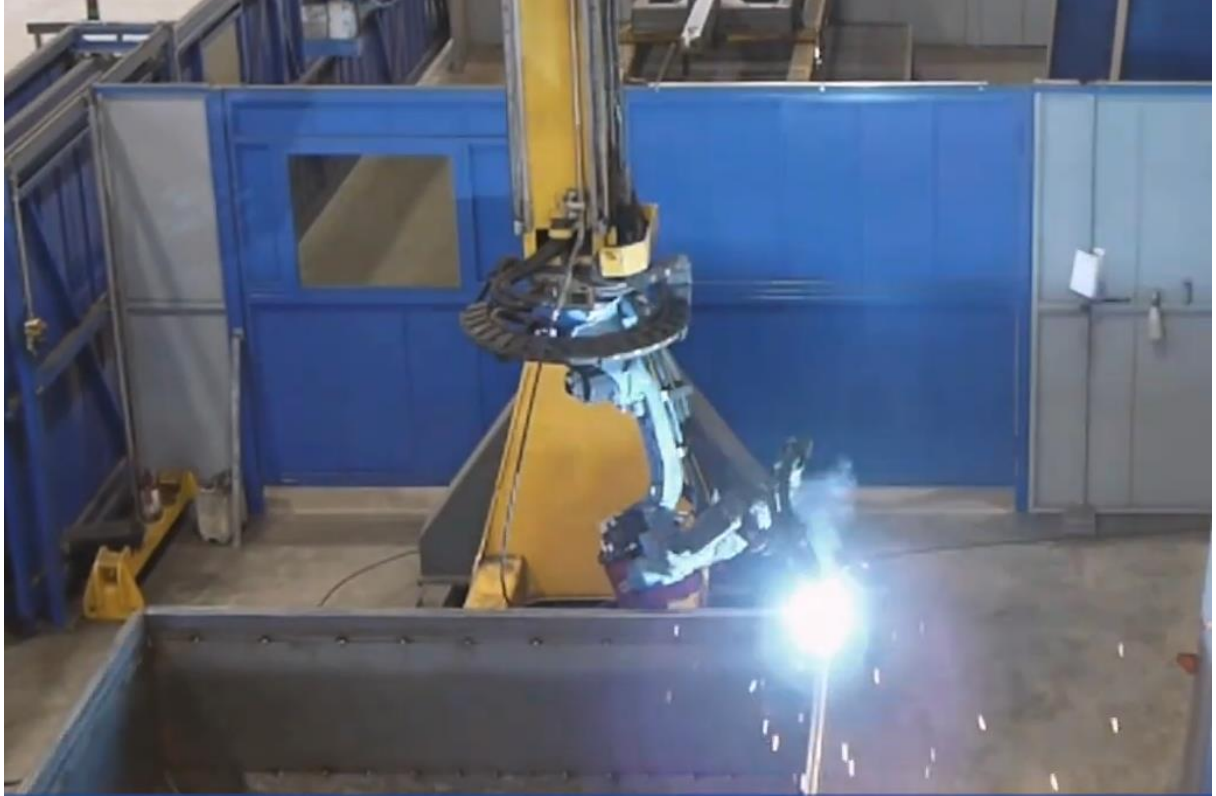
Рис. 1.3 Зварювальний маніпулятор виконує процес зварювання[8]
