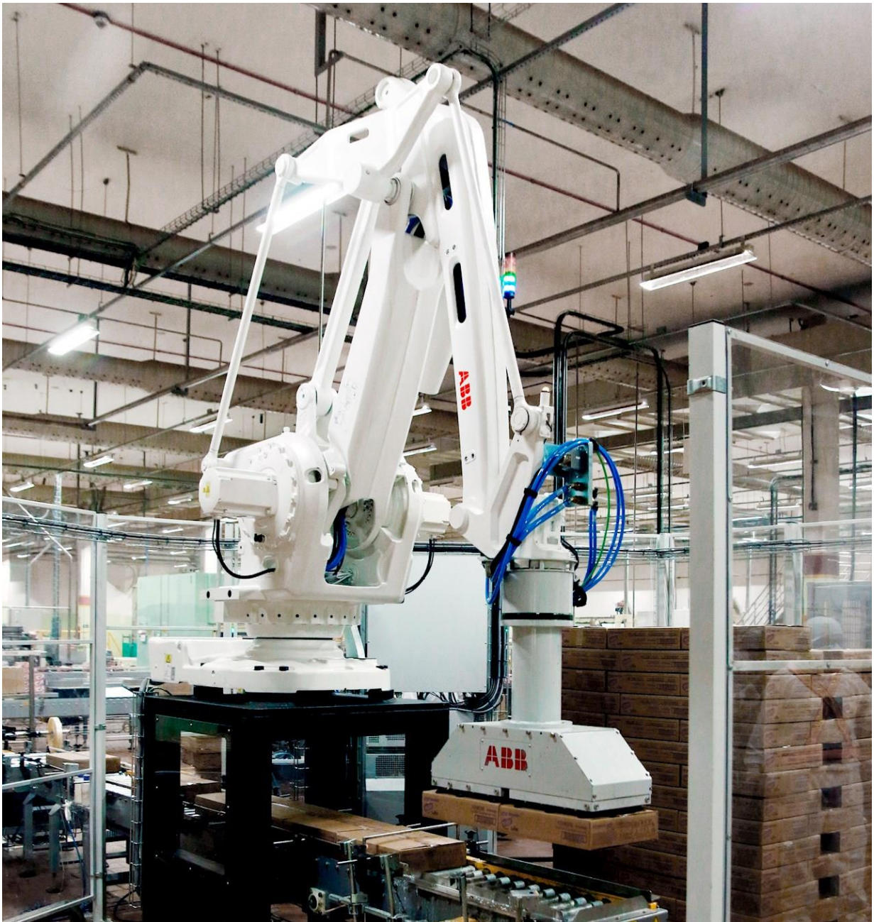
Рис. 1.4 Маніпулятор для палетування АВВ[9]
