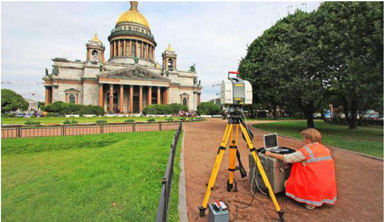
Рис. 1.4 Використання наземного лазерного сканера для сканування фасаду будівлі.
