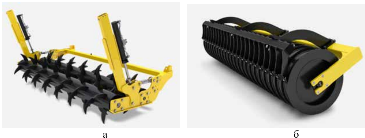
Рис. 2 Додаткові робочі органи глибокорозпушувачів BEDNAR FMT (Чехія): а – котки Tandem Spiked; б – котки Cutpack із скребками
