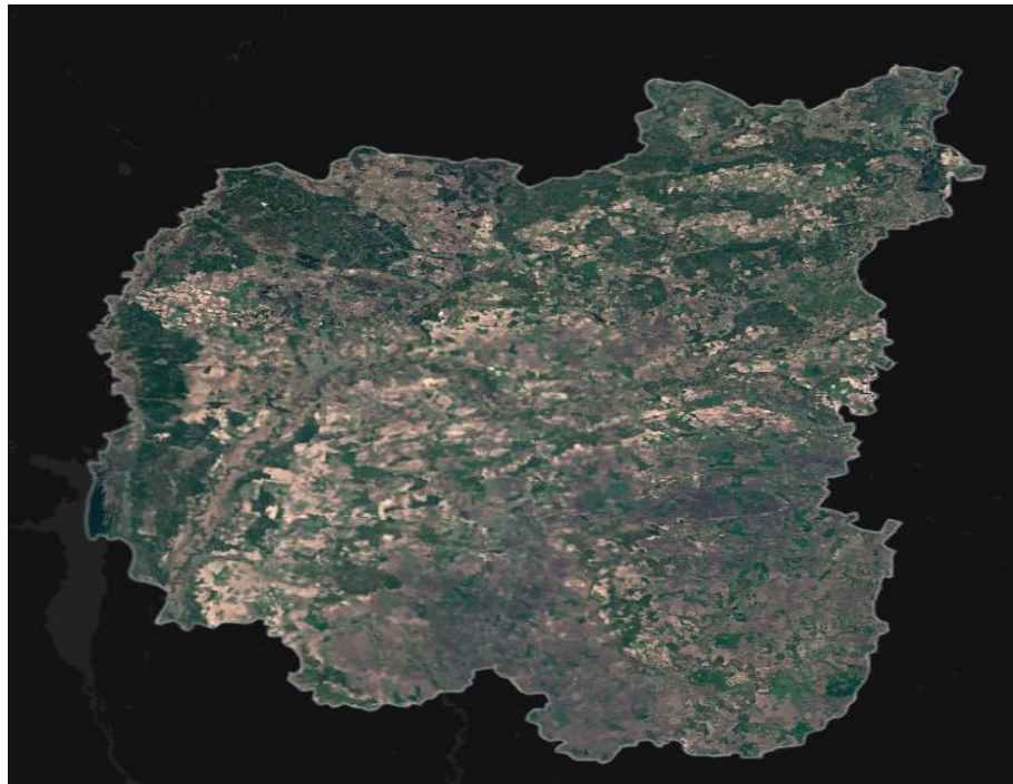
Рис. 2.8. Безхмарна мозаїка супутникових знімків Sentinel 2, сформована за допомогою платформи SEPAL (комбінація каналів: B04-B03-B02)
