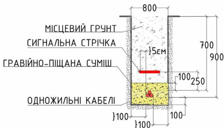
Рис. 2.4. Поперечний переріз траншеї КЛ-10 кВ
