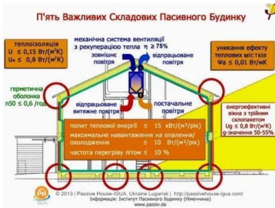
Рис.1.3 Важливі складові пасивного будинку
