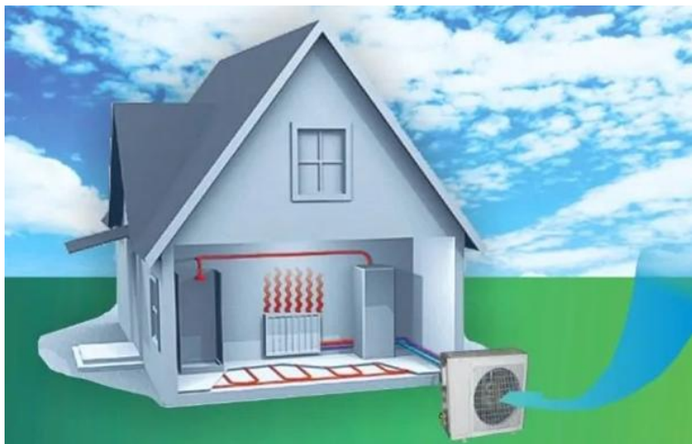
Рис. 3.5 Принцип роботи теплового насосу “повітря-повітря”
