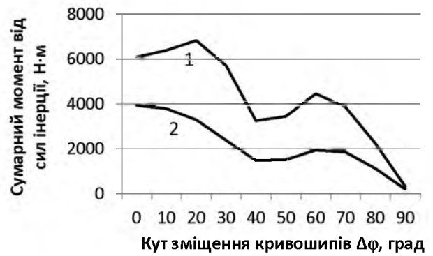
Рис. 3. Графіки зміни максимальних M_{i\max} (1) та середньоквадратичних \bar{M}_i (2) значень моментів від сил інерції в залежності від кута зміщення кривошипів \Delta\varphi
