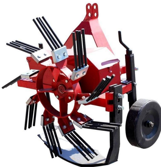
Рис. 2.1. Картоплекопач ротаційний кидального типу
