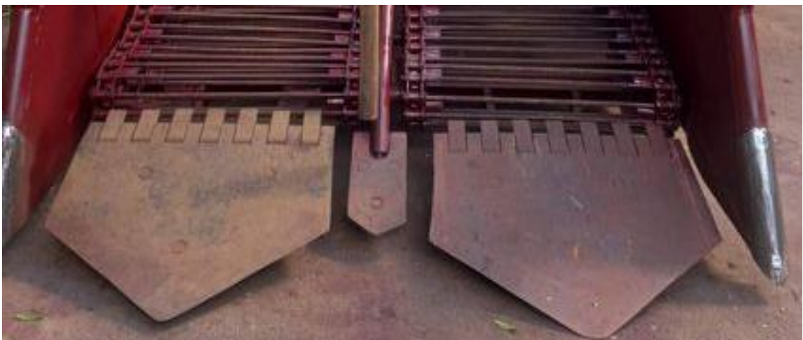
Рис. 2.19 Підкопувальні робочі органи (лемеші) картоплекопача
