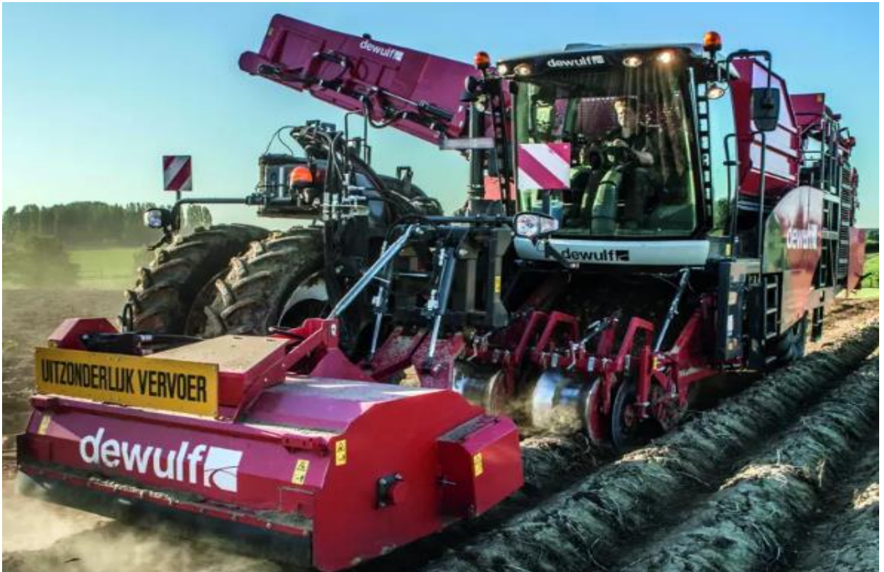
Рис. 2.7 Дворядний самохідний картоплезбиральний комбайн Dewulf RA3060 Essential
