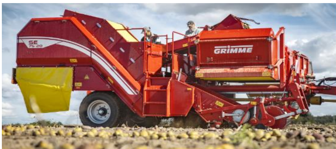
Рис. 2.6 Причіпний однорядний картоплезбиральний комбайн Grimme SE 75-20
