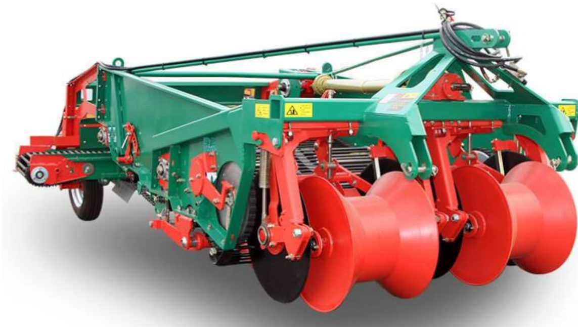
Рис. 2.20 Картоплекопач з котками для руйнування грудок
