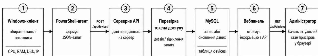
Рисунок 3.20 — Повний цикл передавання даних у системі моніторингу
