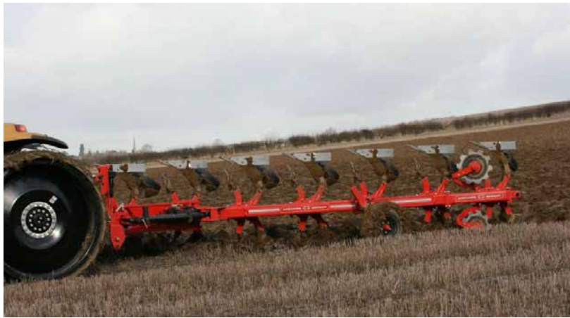
Рис. 2. Навісний семикорпусний оборотний плуг Gregoire Besson HRP-7
