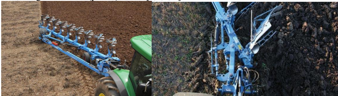
Рис. 1. Напівнавісний плуг плуг Lemken Diamant 12 виконаний за схемою з опорою на колесо
