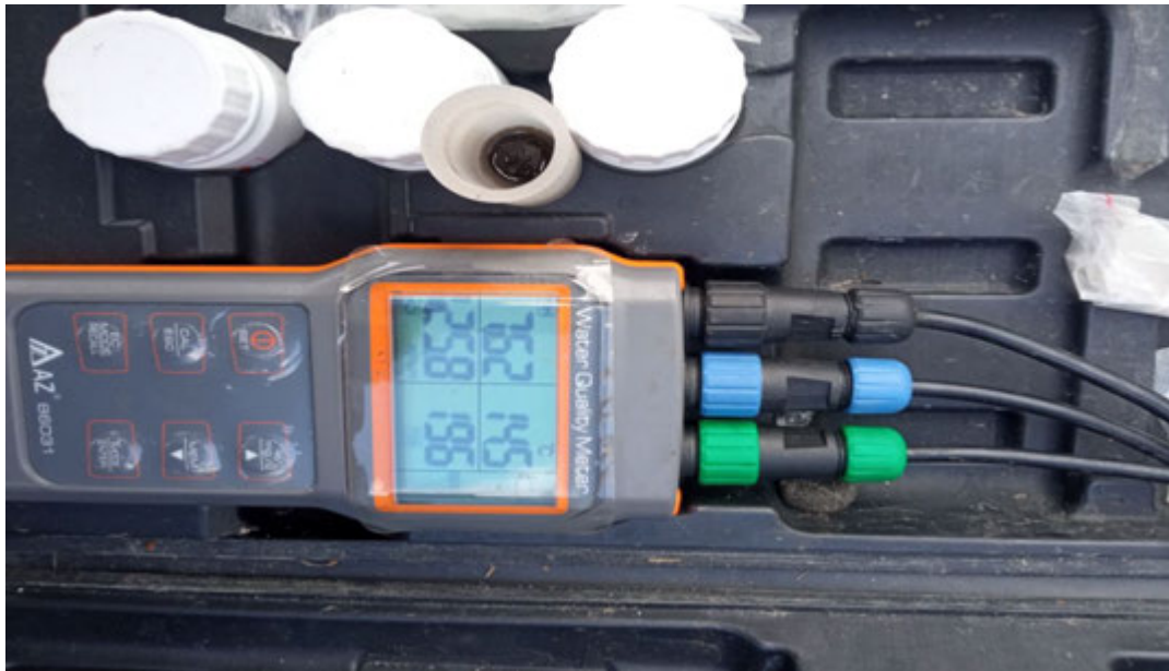
Рис. 2.2. Електронні прилади для визначення кількості кисню у воді
