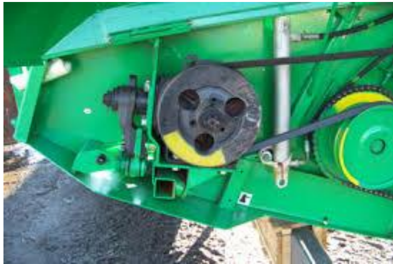
Рисунок 2.7 – Механізм плаваючого ножа (ліва сторона жниварки)
