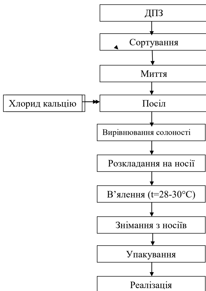
Рис.4.1 Технологічна схема виробництва в'яленої риби
