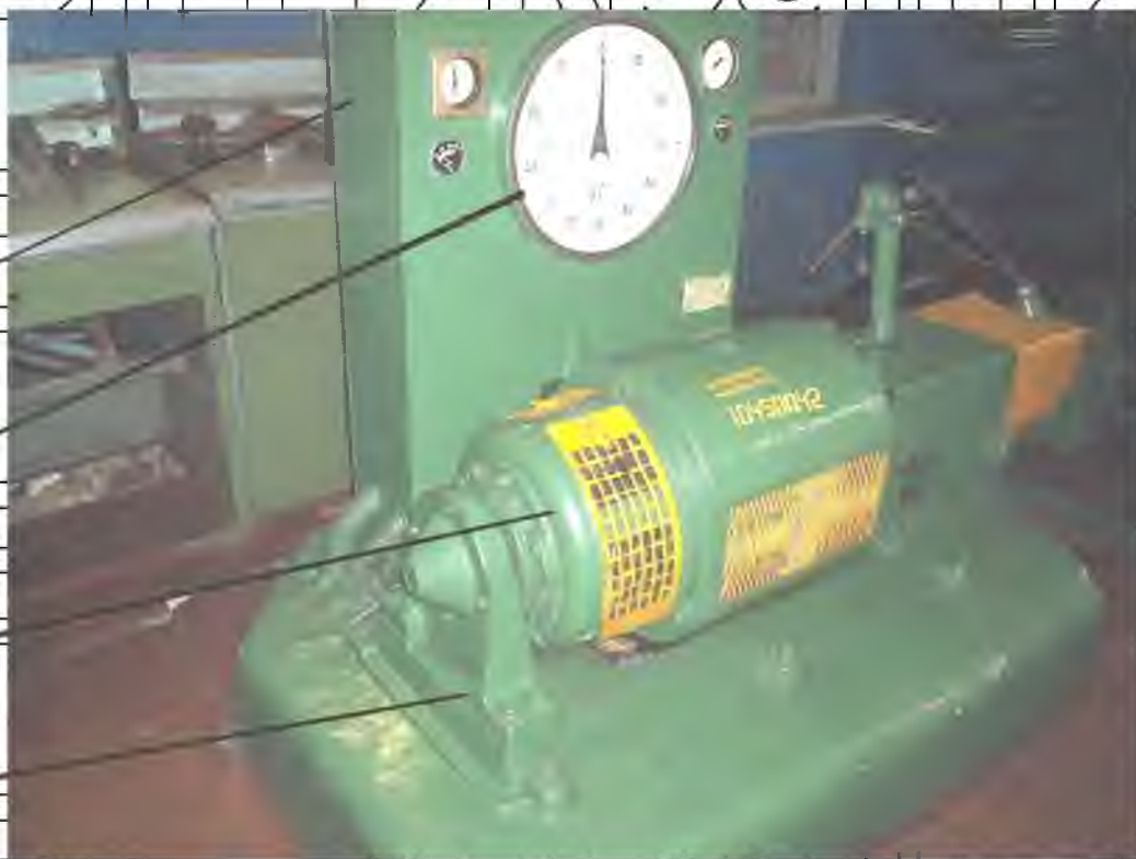
Рисунок 5 Загальний вигляд стенда обкатки і гальмування КІ-1363Б
