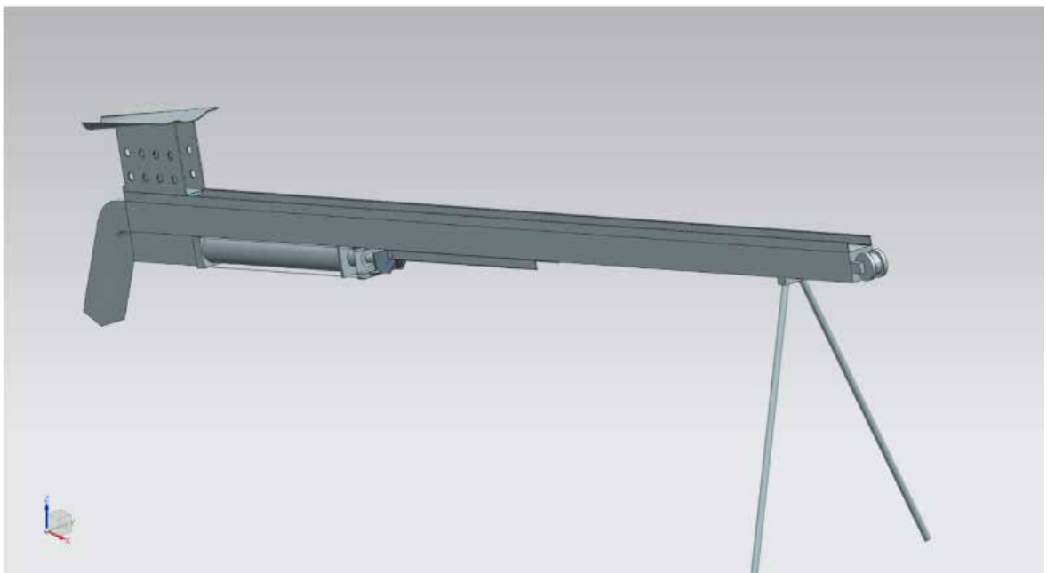
Рис. 3.2. 3D модель катапульти з пневмо-поліспастним приводом
