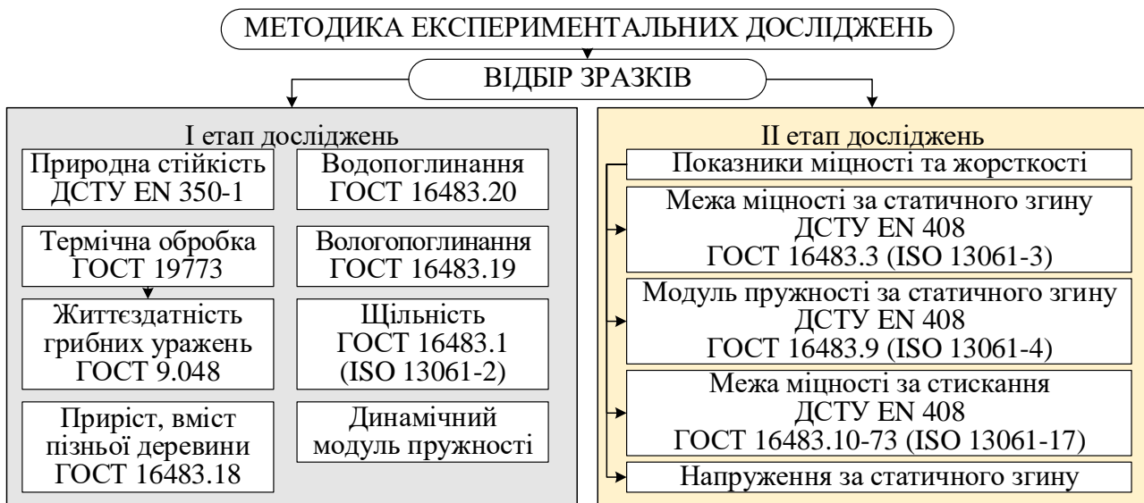
Рис. 2. Блок-схема досліджень властивостей деревини із сухостійних дерев сосни звичайної
