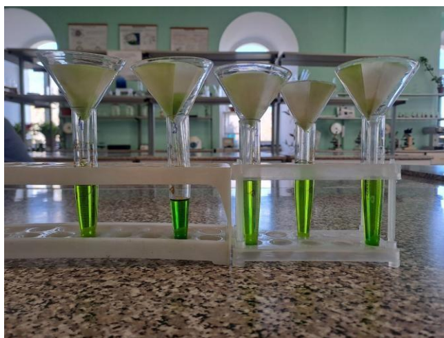
Рис 2.9 Фільтрування етилового екстракту з листків огірка
