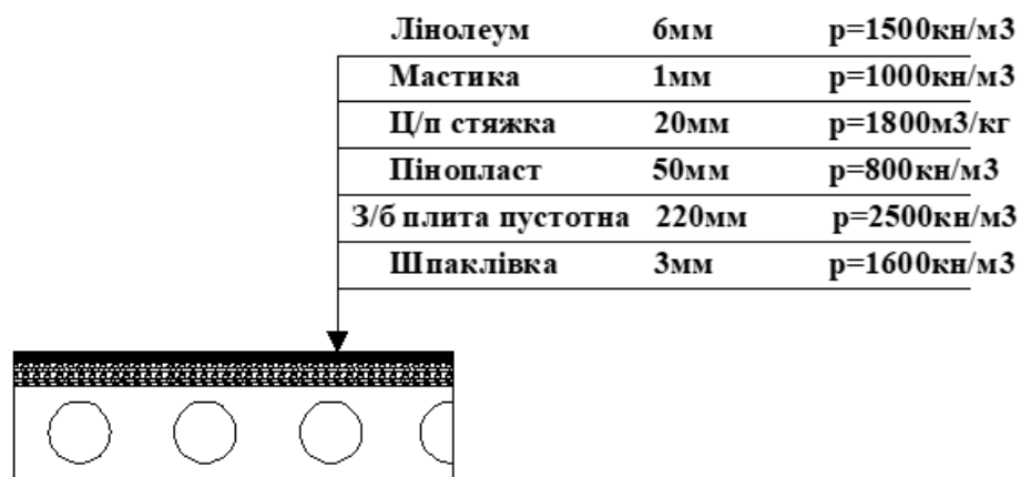
Рис. 2.1 Конструкція підлог
