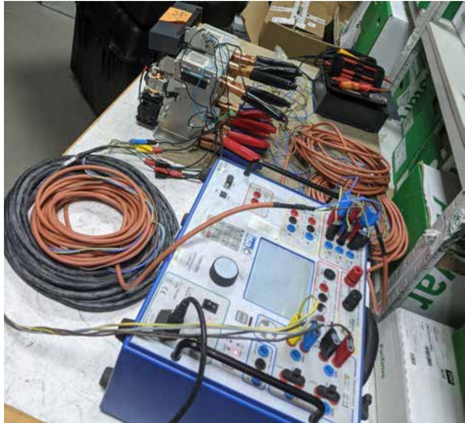
Рис. 5.6.1 – Виконання випробувань вакуумного вимикача в лабораторних умовах
