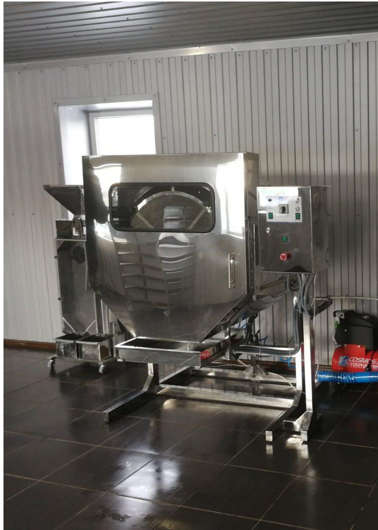
Рис. 4.1. Установка по обезкриленню насіння та гравітаційний сепаратор
